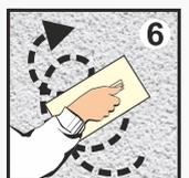
6 После того, как раствор «отвисится», примерно через 5-20 минут, затрите поверхность пластиковой тёркой или металлической кельмой круговыми движениями. В процессе отделки рабочую поверхность кельмы очищайте от налипшей крошки, смачивая в чистой воде и периодически перемешивайте раствор для получения однородной консистенции.
